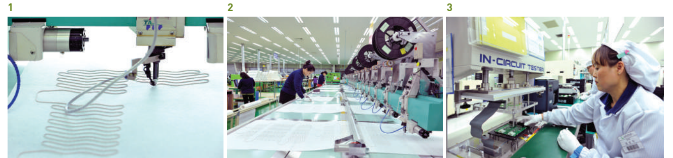
1,2. 열선을 수놓는 기계는 실제 자수기계에 열선 공급장치를 달아 개조한 것이다. 3. 시트히터, 통풍시트, 발열팬들을 작동시키는 데 필요한 통합 콘트롤러(ECU)를 제조하는 모습.
