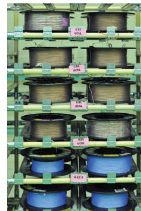
자동차용 시트히터에 들어가는 열선은 0.9mm로 가늘지만, 저항값·내열성·전자파 등 까다로운 기준을 만족시켜야 한다.
